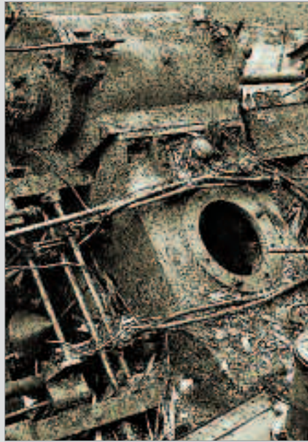
Eine kreisrunde Öffnung mittig im Zylinderstück der umgestürzten S 3/6 markiert jene Stelle, an der die Tragplatte für den Bolzen des Vorlauf-Drehgestells durch die Gewalt des Aufpralls an der Flügelschiene der Weiche abgeschert worden ist.
